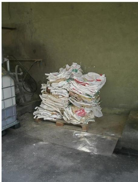
圖 2-18、已清空的原料袋：外層為牛皮紙，內層為防水塑膠袋。
