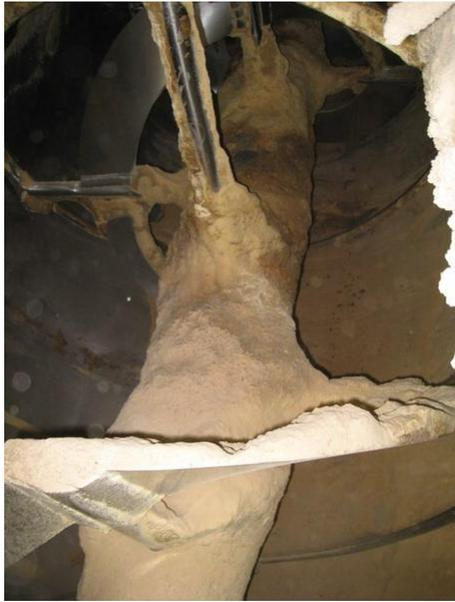
圖 2-30、飼料黏結在混合機的攪拌軸與攪拌葉上。
