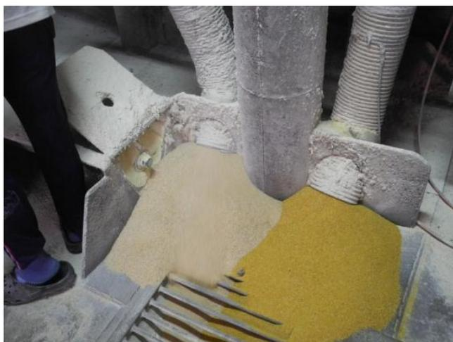
圖 2-54、自配戶混合機原料入料口及其上之管線沾滿粉塵。
