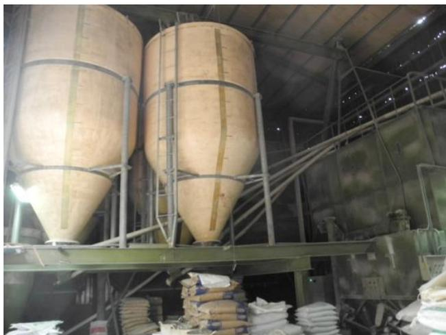
圖 2-55、自配戶的大宗原料散裝筒與管線。
