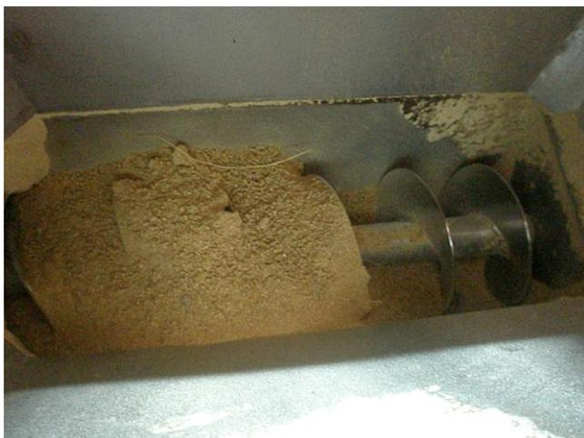
圖 2-34、飼料混合後之螺旋式運輸帶。
