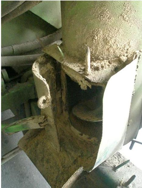
圖 2-51、散裝飼料車車後之採樣口、蓋子、管壁與螺旋輸送軸上所附著的飼料已黴變結塊。
