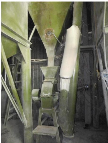
圖 2-53、自配戶之直式混合機與相關管線沾滿粉塵。
