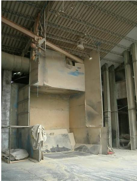
圖 2-4、散裝原料的卸載場所應有遮雨棚。
