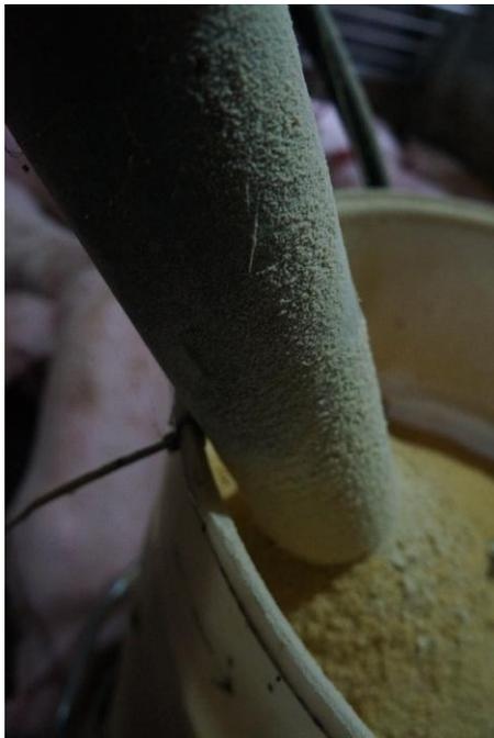
圖 2-83、應定時清除積存於下料的管線外壁與飼料槽內壁、底盤處之飼料以避免發霉。
