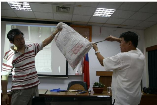
圖 2-73、小採樣棒溝槽朝上，針對飼料袋的四個角落分別插入取樣。
