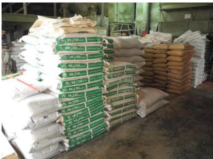
圖 2-57、自配戶小宗原料堆疊情形：缺失為常未用棧板，僅以一塊薄木板墊底，使底部的飼料易受潮，而產生黴變。
