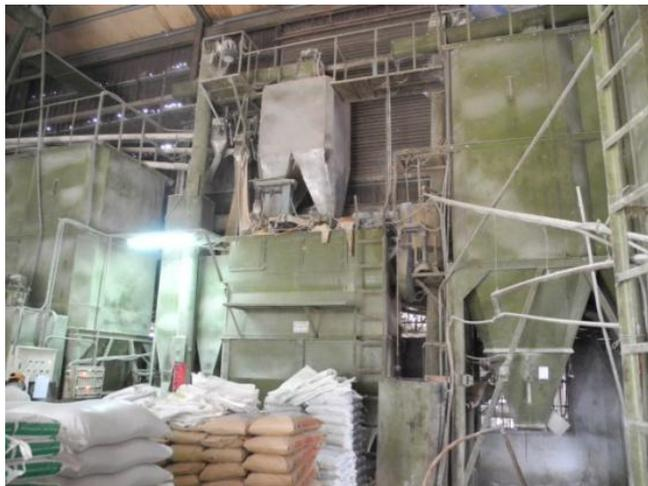
圖 2-52、自配戶橫臥式飼料混合機總覽：其機具、管線沾滿粉塵。
