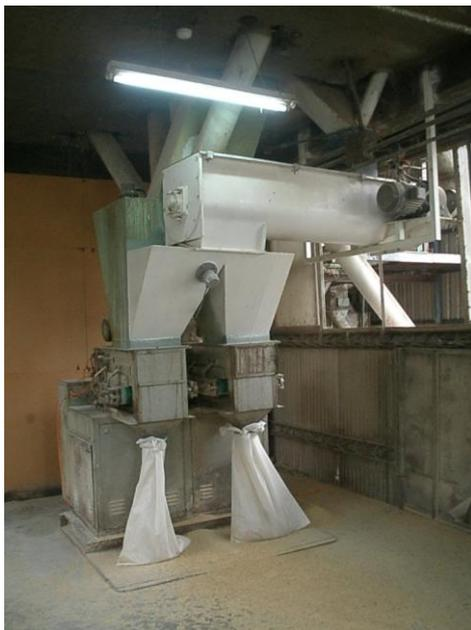
圖 2-44、散落在飼料包裝機外地上之飼料應掃除，
