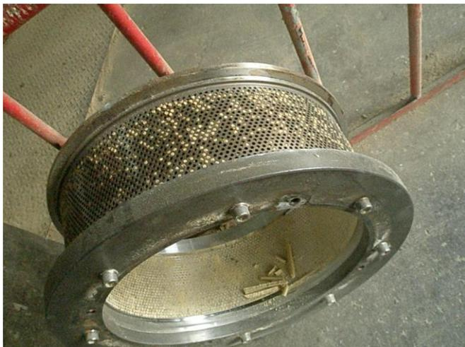
圖 2-36、由打粒機卸下之輪模，應將模孔內的粒料清乾淨以免發霉、污染日後的製粒。
