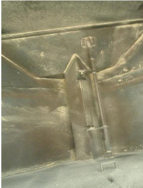
圖 2-50、散裝飼料車之車斗底部粉塵附著例。
