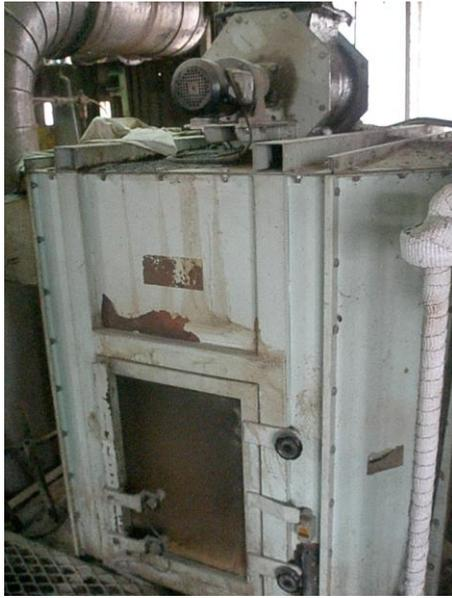
圖 2-43、粒料冷卻機內壁極易附著飼料粉塵。
