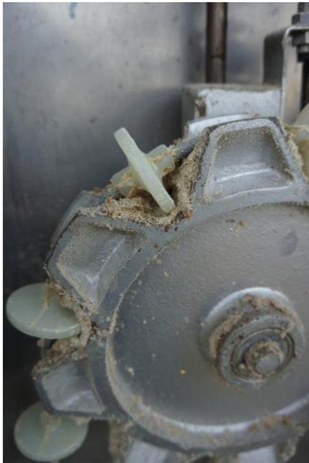
圖 2-81、自動餵飼系統的飼料輸送管線之拖鍊轉盤應定時予以清除積存之飼料以避免發霉。
