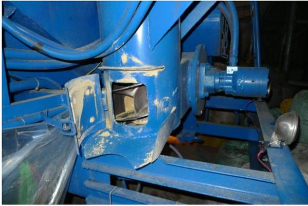
圖 2-61、散裝車車後的採樣口。
