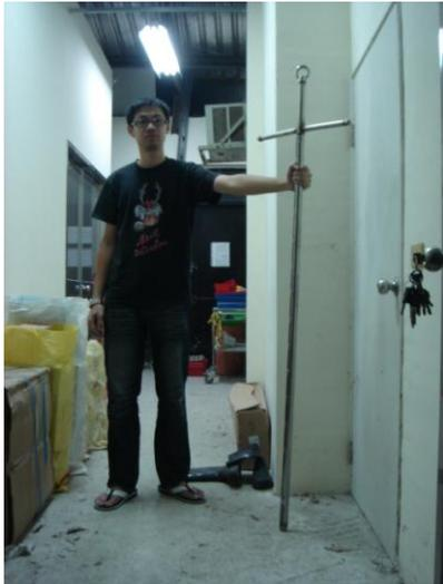
圖 2-58、散裝車採樣用之採樣棒。
