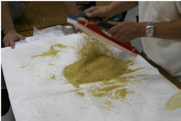
圖 2-63、所收集之樣品以刮刀進行反覆攪拌 5 ~ 6 次。
