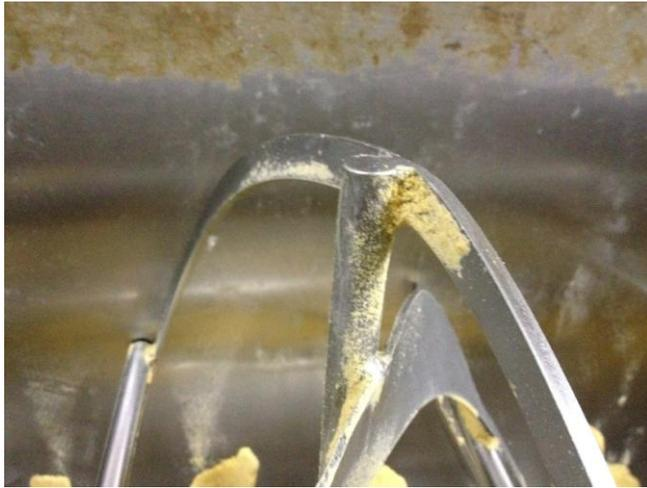
圖 2-32、攪拌葉片角落與混合機內壁遭受粉料附著。
