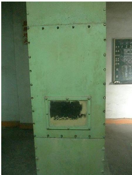
圖 2-25、輸送玉米之管線內壁附著玉米之粉塵。
