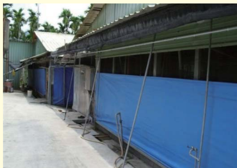
圖 24. 開放式雞舍密閉時圍幕應設計由下往上拉
