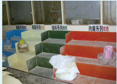
圖4.5 投料暫存區明顯區隔
